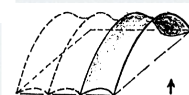
Prefabrikovaný díl střešní Skořepiny do rozponu 25 m hyperbolický paraboloid – dvojí křivost
